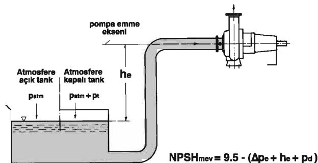
Atmosfere açık tanklı uygulamalarda atmosfer basıncının yaklaşık 9.5 mSS olduğu varsayımyla, sistemin mevcut NPSH değerini hesaplarken emiş hattı direnç kayiplarının toplamı  $\Delta p_e$ , emiş derinliği  $h_e$  ve akışkanın buharlaşma basıncı  $p_d$  formüllerde gösterildiği gibi dikkate alınmalıdır.
